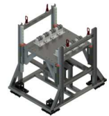
Zdjęcie 4. Zespół niezależnej, regulowanej podpory.
