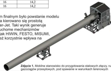
Zdjęcie 1. Mobilne stanowisko do przygotowania stalowych złączy, rur gazociągów przesyłowych, pod spawanie w warunkach terenowych.
