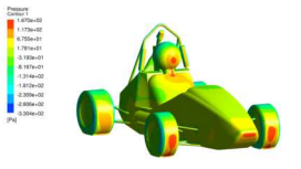
Rys.4. Rozkład ciśnienia statycznego przy prędkości 15 m/s dla bolidu bez pakietu aerodynamicznego
