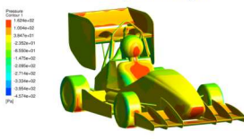
Rys.3. Rozkład ciśnienia statycznego przy prędkości 15 m/s dla bolidu z pakietem aerodynamicznym
