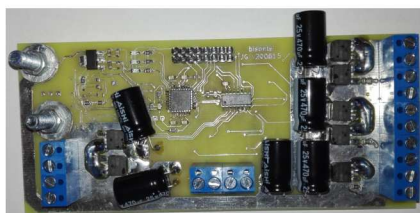
Układ kontroli zasilania. Jedna z płytek PCB wykonanych do projektu.
