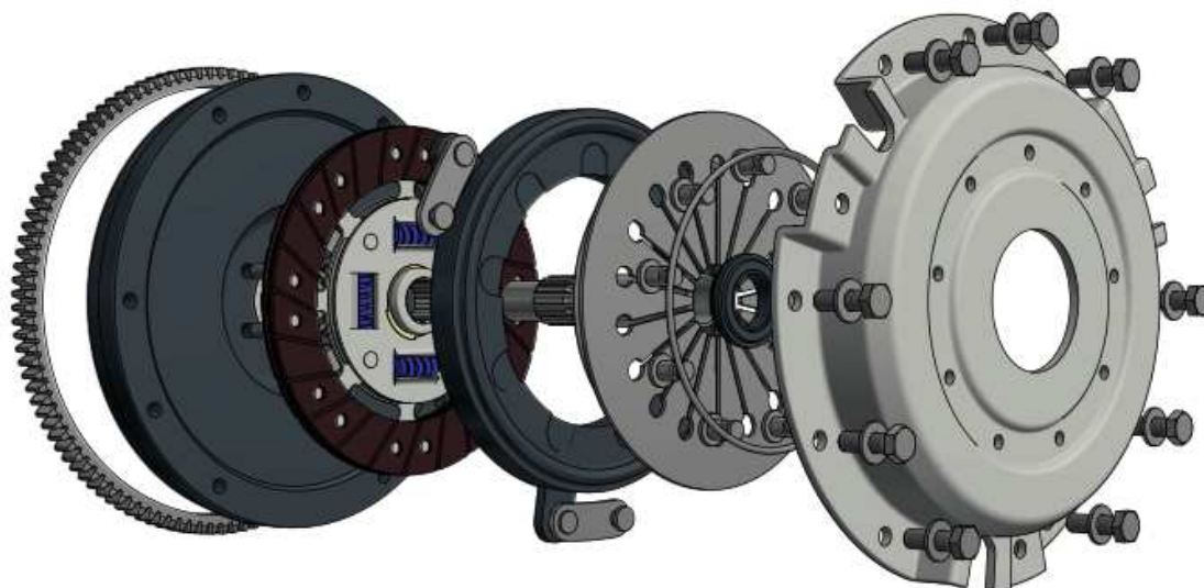
Rys. 2. Model CAD sprzęgła wykonany w ramach pracy dyplomowej
